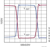
$$\begin{split} &V_S=\pm5V\\ &V_{ICM}=V_{OCM}=0V\\ &R_I=R_F=1k\\ &R_{LOAD}=1k\\ &V_{INDIFF}=18V_{P-P}\\ &SINGLE-ENDED\ INPUT \end{split}$$
